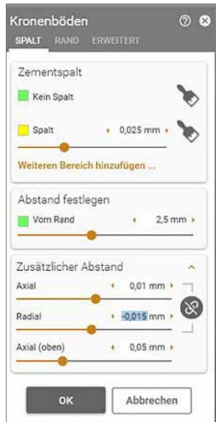
Parameter der Sekundärteleskope mit einer 2° Fräsfläche
