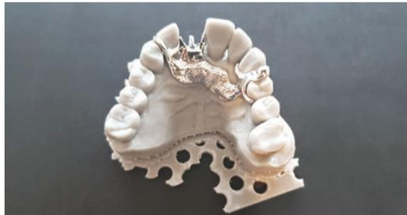
Abb. 3 Für die Fertigstellung der provisorischen Klammerprothese muss die bereits poliert gelieferte, im SLM-Verfahren bei Bego gefertigte Kobalt-Chrom-Struktur später nur noch mit dem ebenfalls CAD/CAM-gestützt gefertigten, individuellen Prothesenzahn aus VarseoSmile Crown<sup>plus</sup> verbunden werden.
