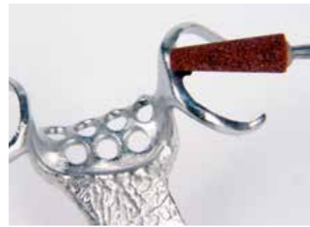
Ausarbeiten mittels Korund- bzw. Feinschleifkörper
