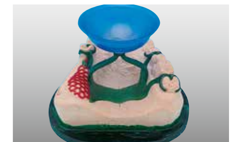
Ansetzen der Gusskanäle im Oberkiefer Guss von oben
