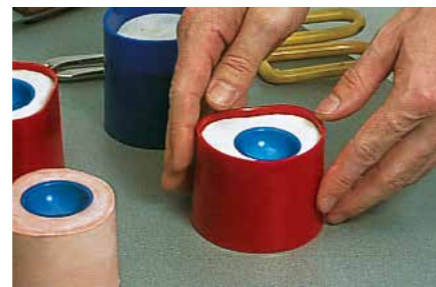
Aushärtezeit 30 Min. für den konventionellen Guss
