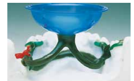
Ansetzen der Gusskanäle im Unterkiefer, Guss von oben
