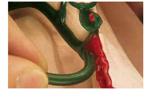
Gusskanäle gebogen ansetzen
