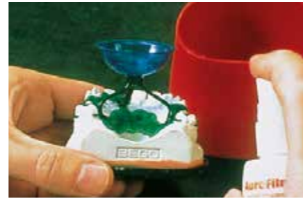
Wachsoberfläche mit Aurofilm entspannen Modell auf angewachster Sockelplatte
