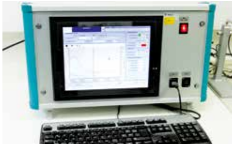
Qualitätskontrolle: Das Dilatometer ermittelt die thermische Expansion der BEGO Einbettmassen
