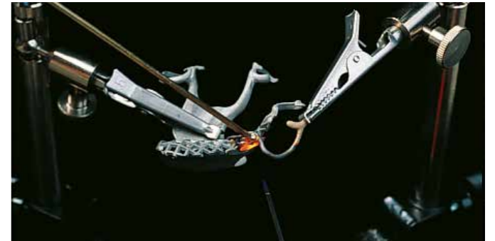
Anlöten einer konfektionierten Goldklammer
