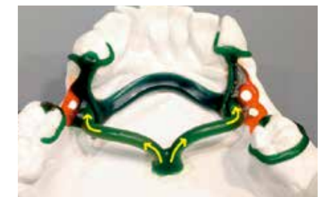
Guss durch das Modell, Gusskanäle gebogen ansetzen
